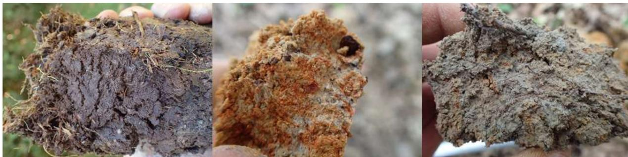
Figure 2. Horizons histique, rédoxique et réductique observés lors de sondages pédologiques
